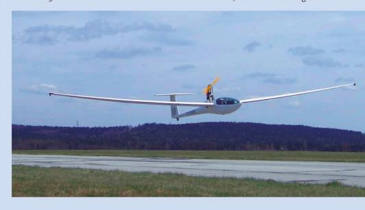
die Rumpföffnung auszugleichen. Die DGtypische, sehr große Haube ermöglichte eine grandiose Rundumsicht, aber sorgte für warme Beine bei den Piloten. Das Spornrad war lenkbar und in Kombination mit den Rädchen in den Flügelspitzen konnte der Pilot tatsächlich völlig ohne fremde Hilfe starten.
