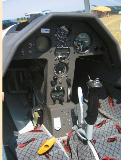
Das Cockpit des Discus. Die Bremse des Einziehfahrwerkes wird über diesen Handbremshebel am Knüppel bedient.
