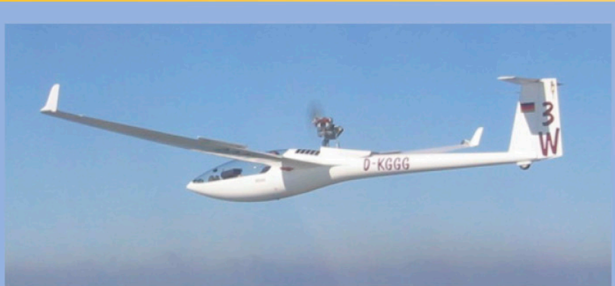
Gregor Gaida hat seine GG-300 als Einzelstück mit einem Solo-Klapptriebwerk zum Motorsegler umgebaut. (Detailsunter: http://www.drgaida.de/Entwicklung%20GG300.htm )
